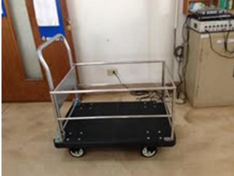
รูปที่ 4.8.1 รูปแสดงรถเข็นสำหรับเคลื่อนย้ายของเสียสารเคมีและของเสียอันตราย
